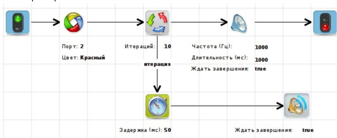
Рисунок 6. Пример диаграммы на языке описания алгоритма работы робота в системе QReal
