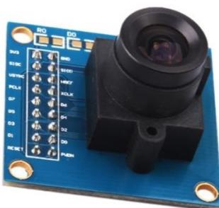
Рисунок 3. «Видео-модуль ov7670»
