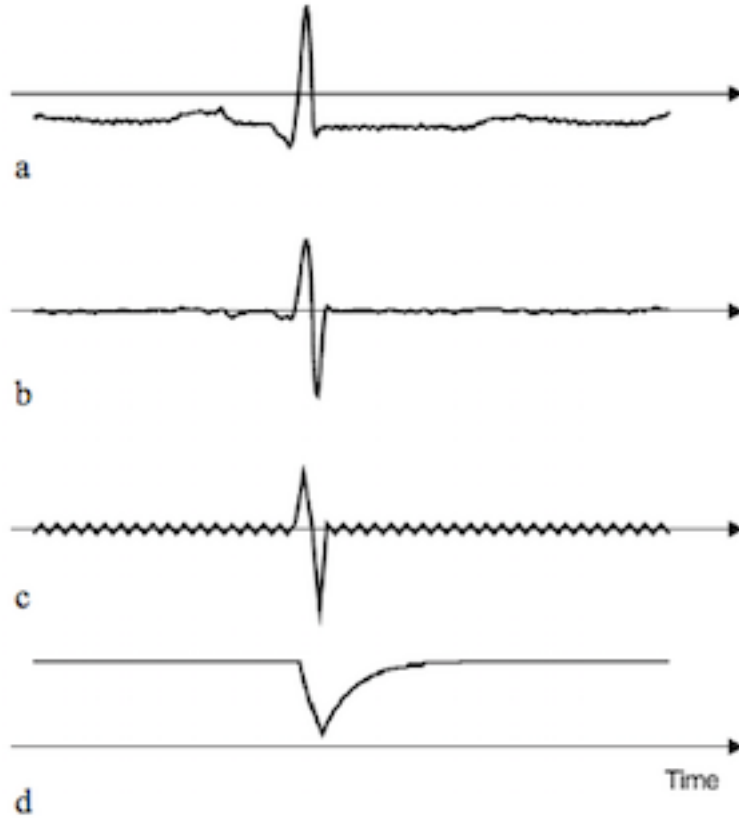
Рис. 3: ЭКГ сигналы в разных стадиях выделения особенностей: а) Исходный ЭКГ сигнал, б) Отфильтрованный сигнал, в) Сигнал с добавленной высокочастотной последовательностью, д) Количество пересечений с нулем для некоторого окна.
