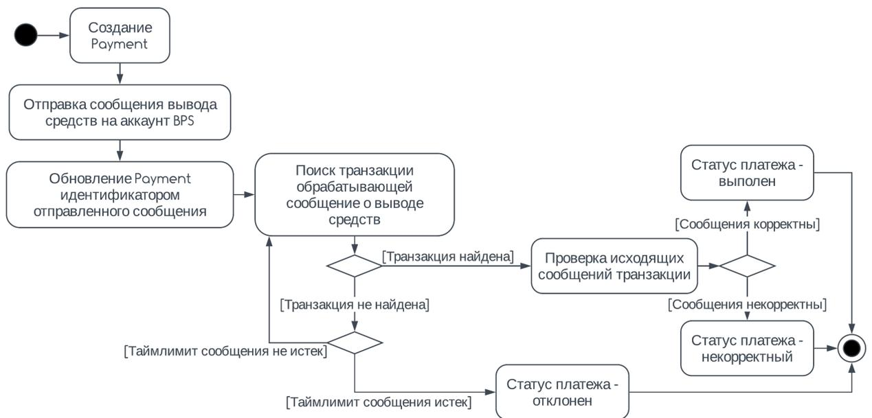
Рис. 8: Процесс вывода Gram из платежной системы BPS
