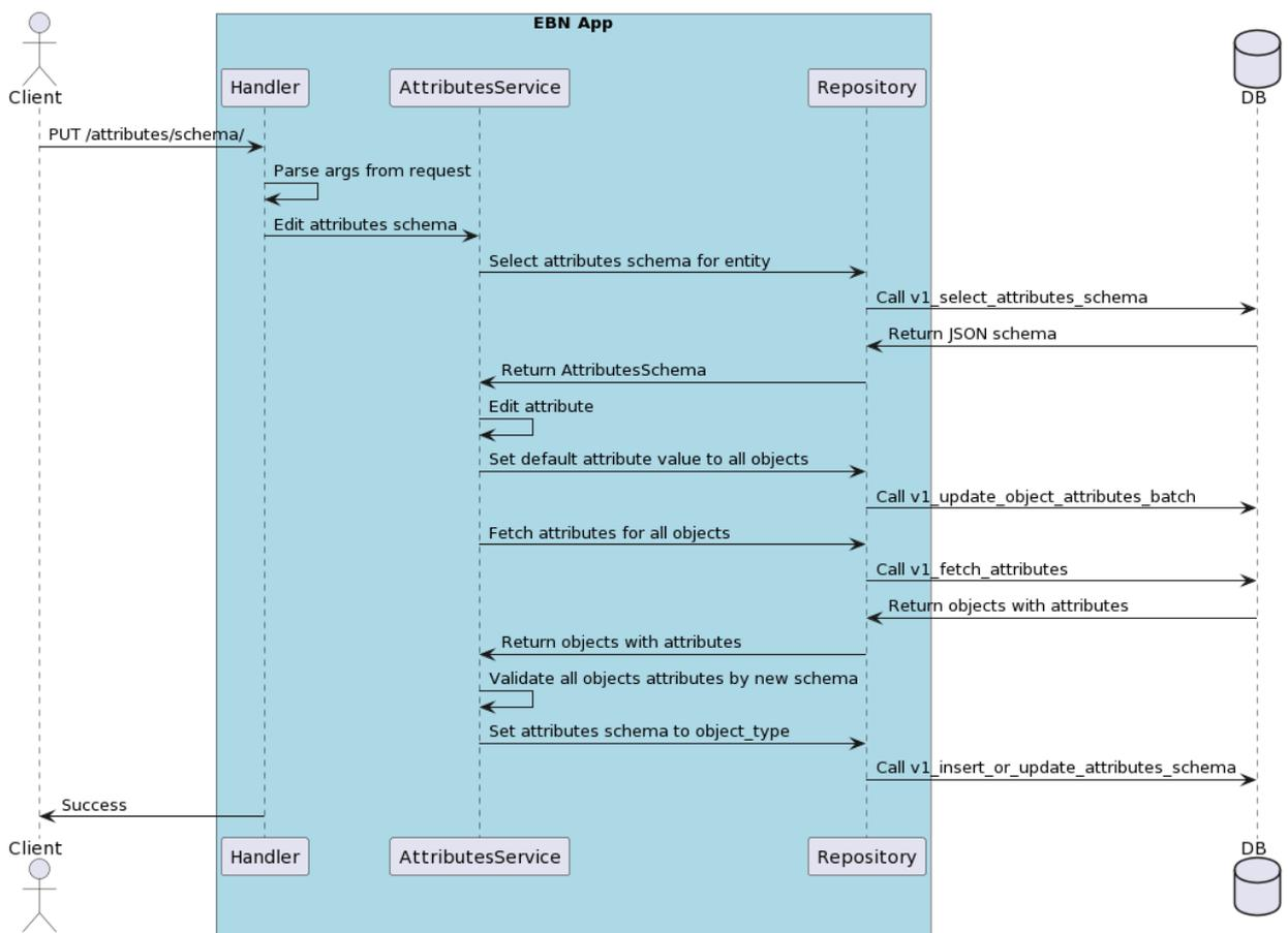
**Рис. 8:** Схема работы обработчика, изменяющего конфигурацию атрибута у сущности.
