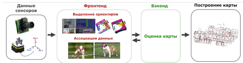
Рис. 1: Принцип работы SLAM-алгоритмов [39].
