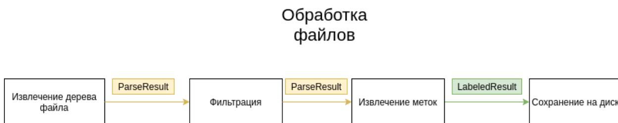
Рис. 12: Шаги обработки данных при уровне гранулярности "файл"
