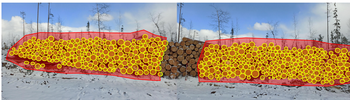
Рис. 8: Торцы, отфильтрованные по пользовательской области
