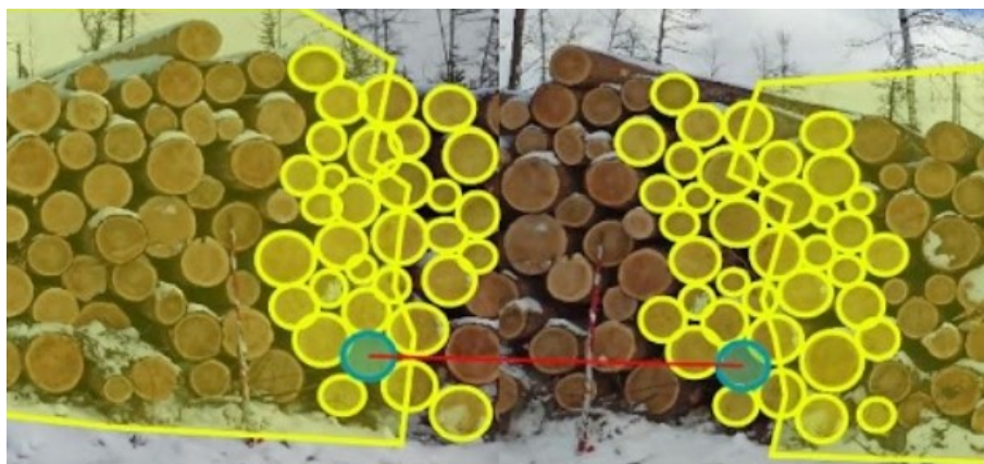
Рис. 16: Торцу на левом изображении сопоставлен только один торец на правом
