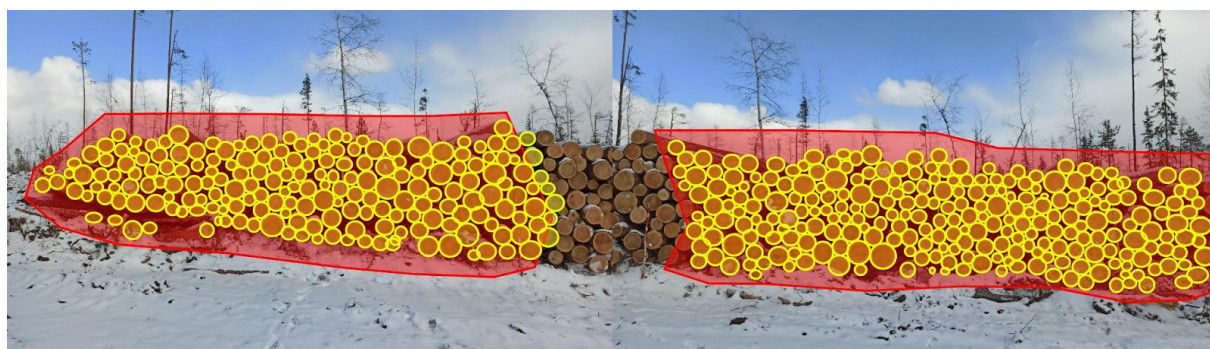
Рис. 2: Результат работы простого алгоритма исключения дублирующихся торцов. Красным выделена отмеченная пользователем область интереса, жёлтым — торцы, которые будут учтены при подсчёте объёма
