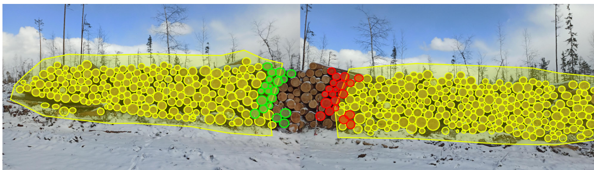
Рис. 9: Уточнение границы по найденным сопоставлениям. Торцы, для которых сопоставление было найдено, отмечены зелёным на левом изображении и красным на правом и будут включены в результирующее множество слева и исключены из него справа
