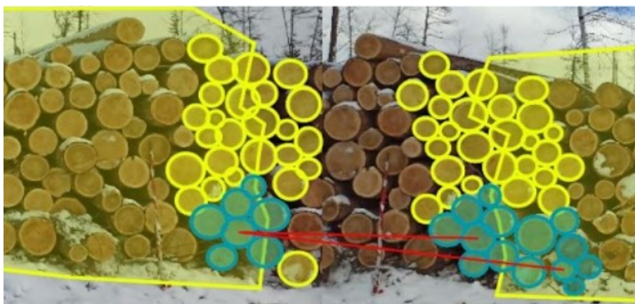
Рис. 14: Торцы, лежащие в окрестностях сопоставленных торцов (отмечены синим)
