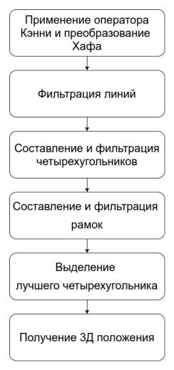
Рис. 3: Диаграмма активности алгоритма, определяющего трёхмерное положение для одного кадра
