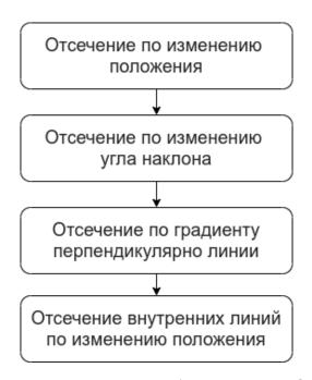
Рис. 4: Диаграмма активности, отображающая фильтрацию линий
